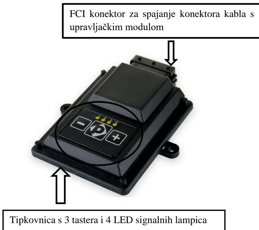
**Napomena:** Tipkovnica je aktivna samo određeno vrijeme (90 sekundi) nakon pokretanja motora. Nakon tog vremena ulazi u fazu neaktivnosti te više nećete biti u mogućnosti raditi bilo kakve promjene preko tipkovnice. Da biste mogli raditi bilo kakve promjene morate zaustaviti motor, te ga ponovo pokrenuti.
